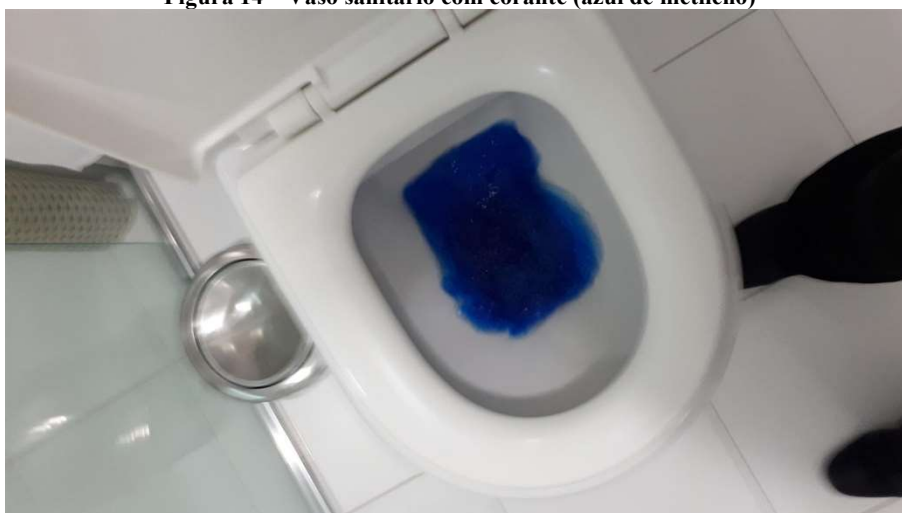
Figura 14 – Vaso sanitário com corante (azul de metileno)
